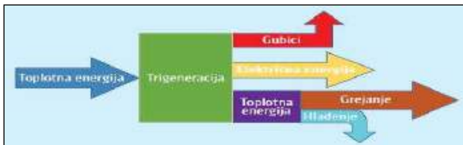
Slika 1: Šematski prikaz trigeneracije (Genić et. al, 2017; str. 13)
