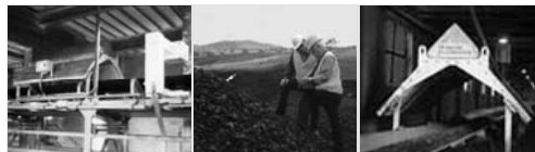
Slika 2. Prikaz montiranog analizatora "HeatEye" u funkciji na tračnom transporteru i operacionalizacija analize na terenu
