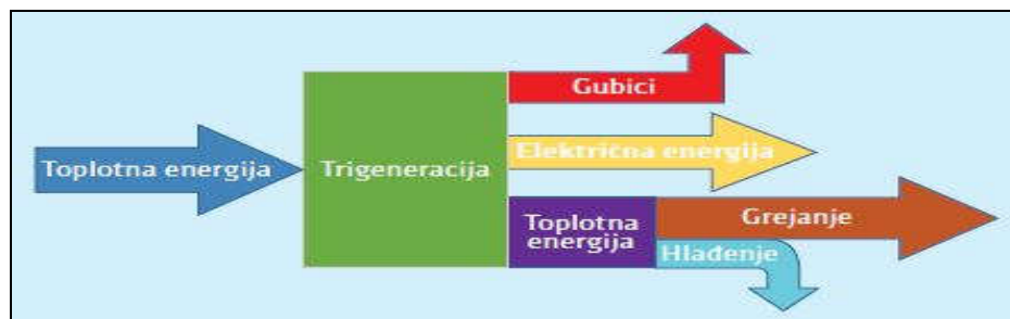
Slika 1: Šematski prikaz trigeneracije (Genić et. al, 2017; str. 13)
