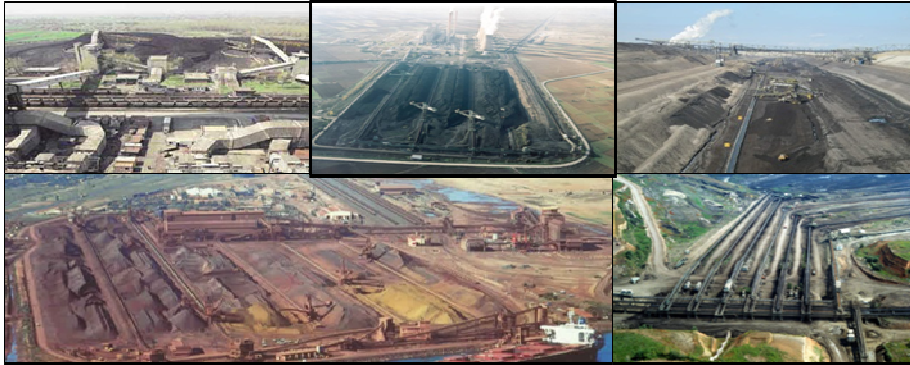
Slika 2. Prikaz savremenih sistema za homogenizaciju uglja locirane na površinskim kopovima ili deponijama termoelektrana, [9]
